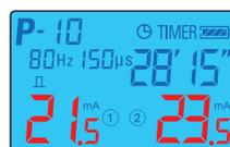
Attention : Verrouillage automatique des intensités. Pour déverrouiller baisser l'intensité puis remonter au niveau souhaité
